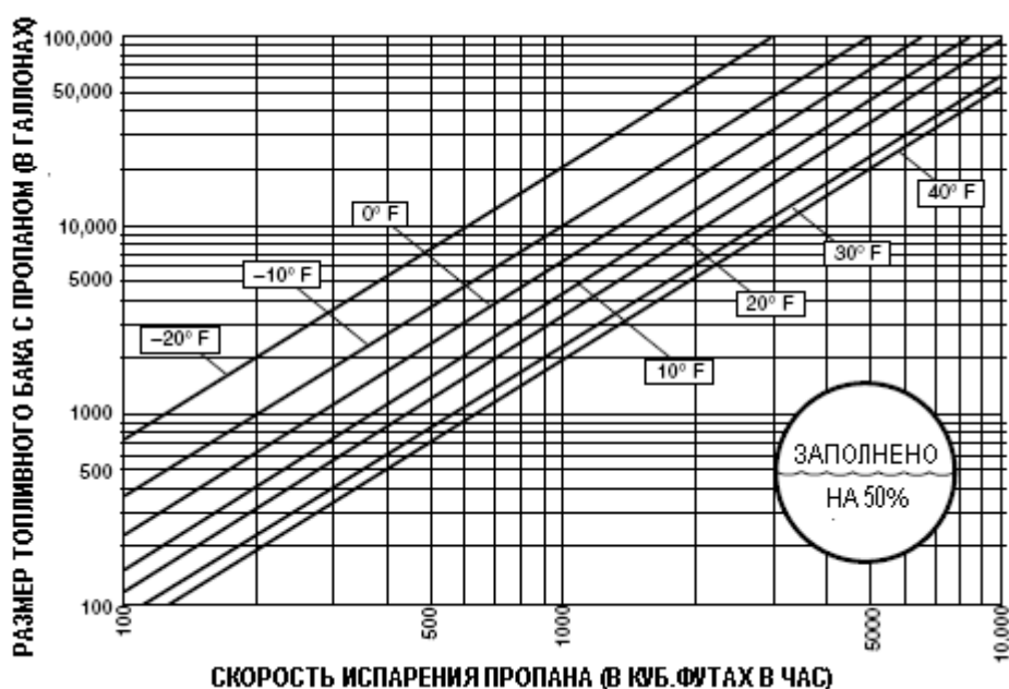
Рис. 6–70. Минимальный размер бака LPG (заполненный на 50%), необходимый для поддержания избыточного давления 5 фунтов на кв.дюйм при удельной скорости отбора и ожидаемой минимальной температуре в зимнее время года
