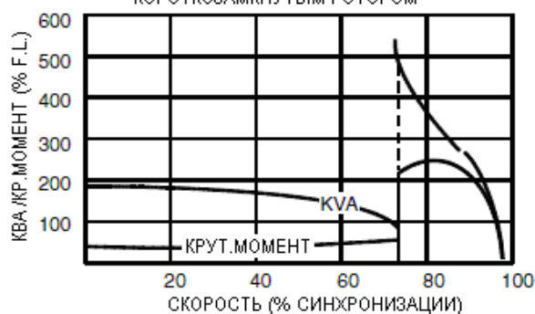
ТИПОВЫЕ КРИВЫЕ КВА И КРУТ.МОМЕНТА АСИНХРОННОГО ЭЛЕКТРОДВИГАТЕЛЯ С КОРОТКОЗАМКНУТЫМ РОТОРОМ
