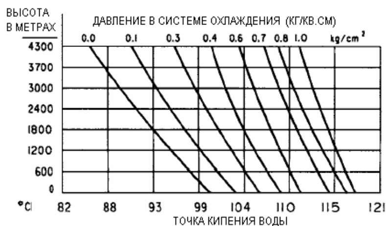
Рис. 6-31. Температура кипения воды в зависимости от высоты и давления ОЖ в системе
